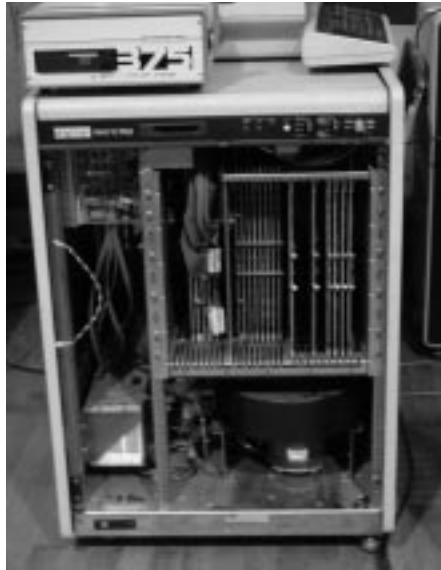
Unten eine VAX 11/750, oben eine Symmetric 375. Letztere hiess im Hacker-Volksmund "HalfVAX", teilweise wegen ihres Namens, teilweise, weil sie auf einer VLSI-VAX-Lookalike-Architektur mit 16 statt 32 Bit Busbreite basierte.
