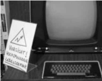
Konsole einer Control Data Cyber. Cyber war als Number Cruncher in den 70er Jahren unter Mathematikern sehr beliebt. Programme wurden üblicherweise auf Lochkarten zugeführt. Grafische Ausgaben erledigte ein Plotter oder diese Vektorkonsole. CDC-Systeme waren auch unter den ersten, die in Berlin über Modem-Pools verfügten und so Hackern zur Kommunikation dienten.
